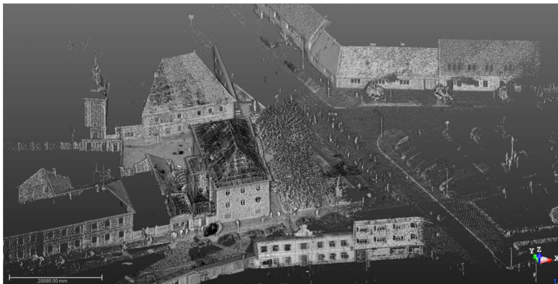
Obrázek 35: Celé naskenované mračno před očištěním
