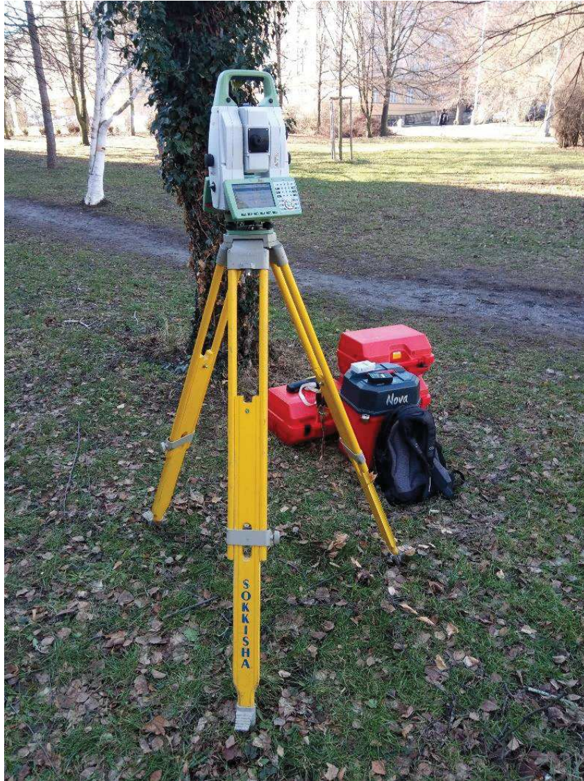
Obr. 15 - Stanovisko s přístrojem Leica MS60 při experimentu
