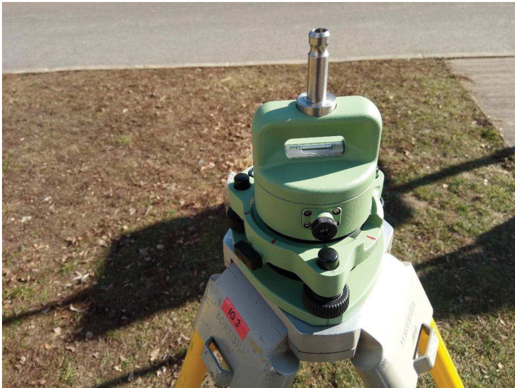
Obr. 21 - Určování náklonů optickým centrovačem Leica GZR3
