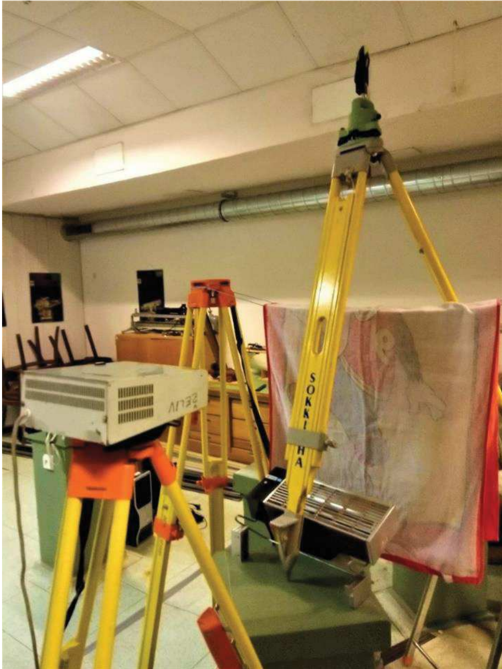
Obr. 31 - Umístění přímotopů a tepelné izolace
