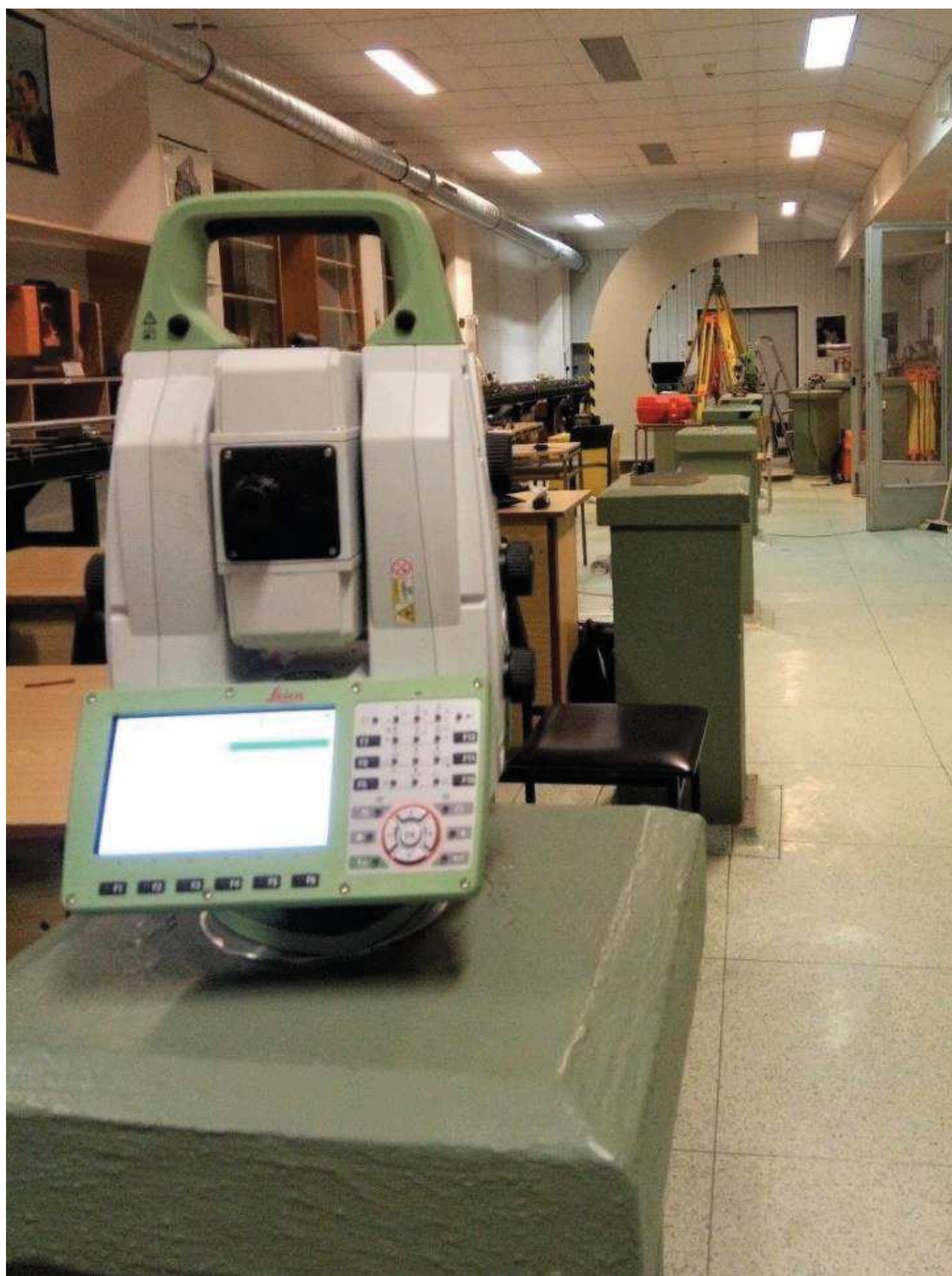
Obr. 30 - Nucená centrace při experimentu v laboratoři
