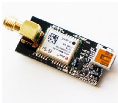
Obrázek 11.5: GNSS modul - NEO-M8T
