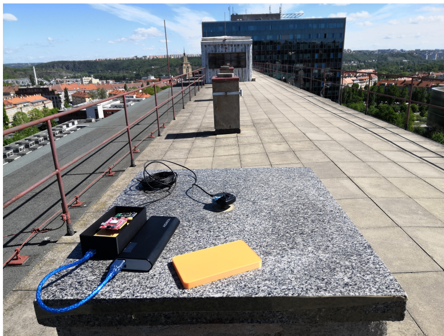
Obrázek 13.1: Testování přijímače - měření souřadnic pilíře magnetickou anténou u-blox
