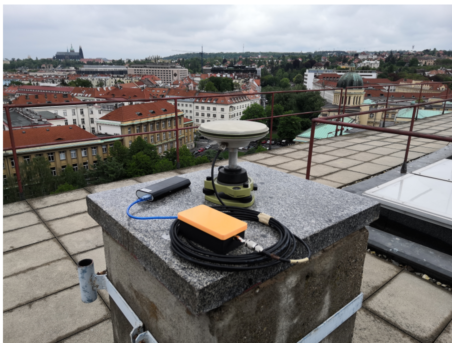
Obrázek 13.3: Testování přijímače - měření souřadnic pilíře geodetickou anténou Leica AX1202GG
