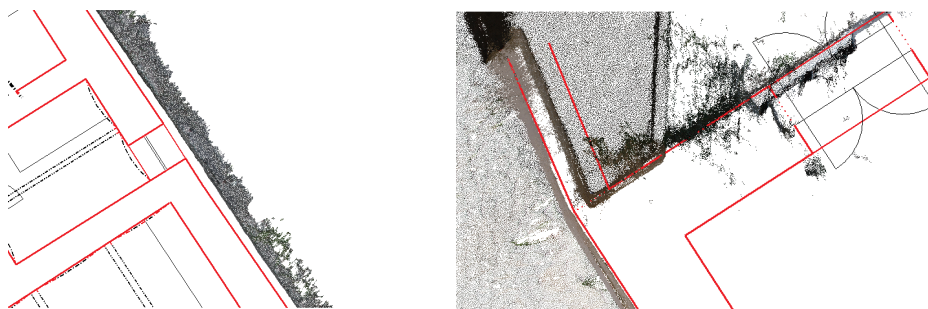
Obr. 6.15: Rozdíl půdorysu a mračna bodů [autor]
