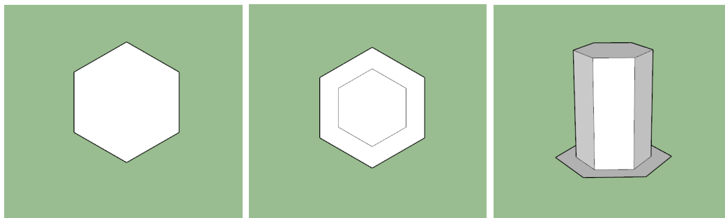
Obrázek 4.3: Ukázka nástrojů Polygon , Offset a Push/Pull
