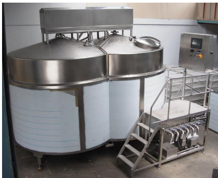
Obrázek 19 Vertikální výrobek sýřeniny (prezentace firmy C. van ,t Riet / Dairy Technology USA) [O19]
