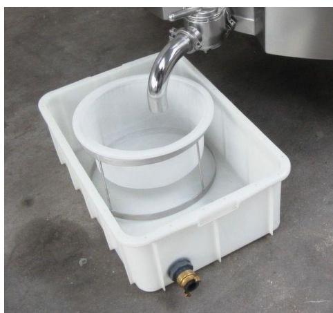
Obrázek 24 Ventil na výpust syrovátky (prezentace firmy C. van ,t Riet / Dairy Technology USA) [O24]
