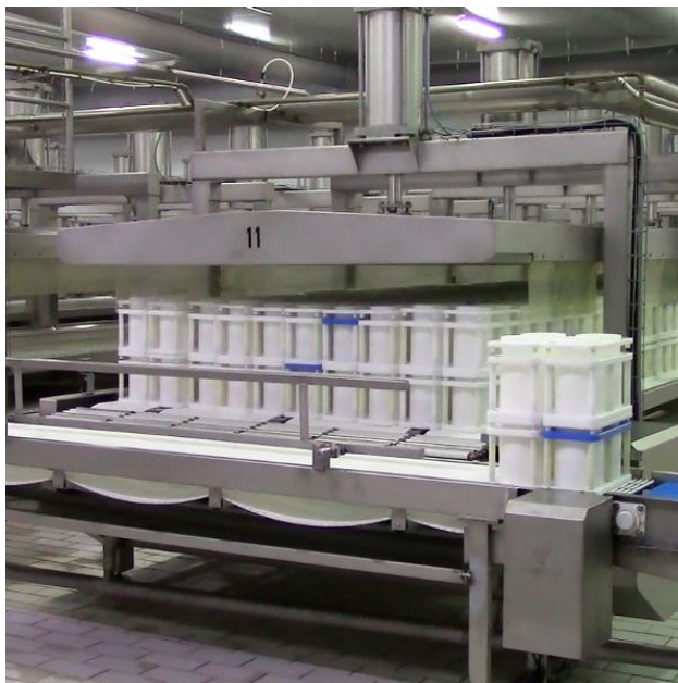
Obrázek 29 Pneumatický lisovací systém (prezentace firmy S.L. Corporacion Fibosa Internacional) [O29]
