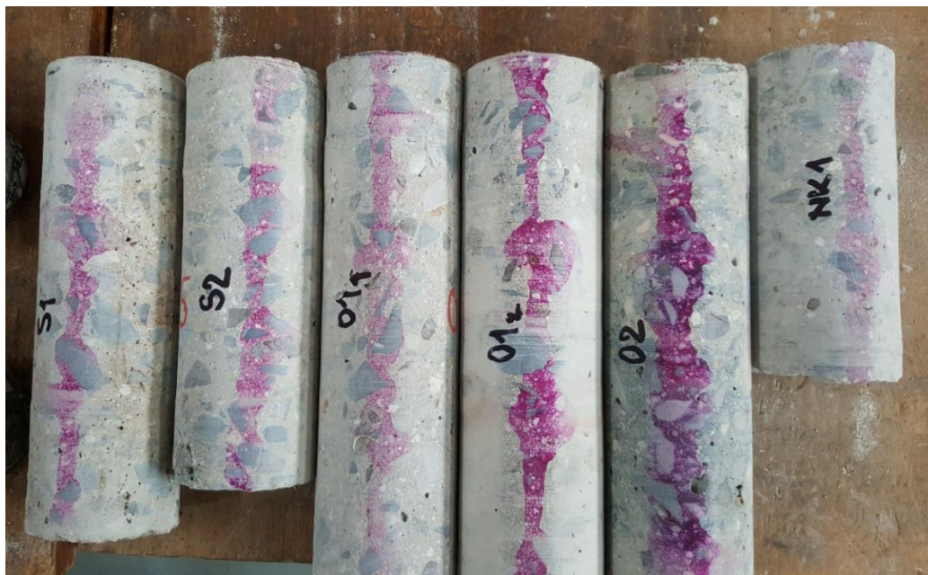
Obr. 1: Fenolftaleinová zkouška úrovně karbonatace betonu na jádrových vývrtech [1.15]
