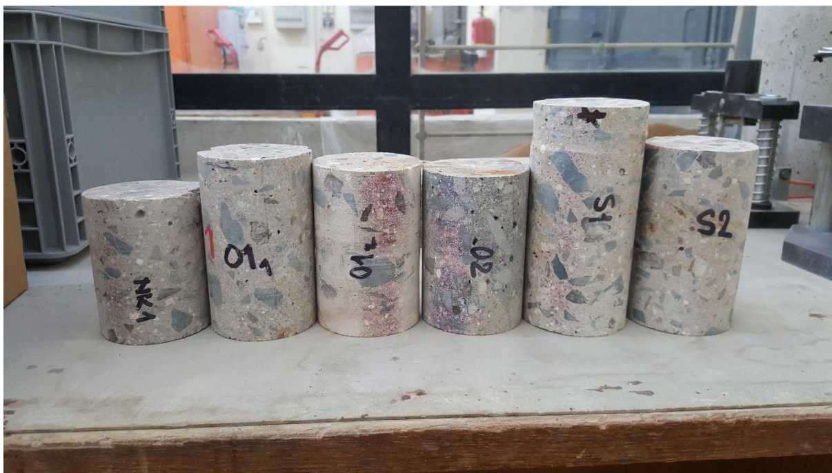
Obr. 7: Odebrané a upravené jádrové vývrtky pro zkoušku v tlaku [1.15]
