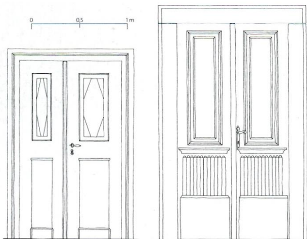
Obr. 2.6 Ukázka dvoukřídlových klasicistních rámových dveří z 1. poloviny 19. století [1]
