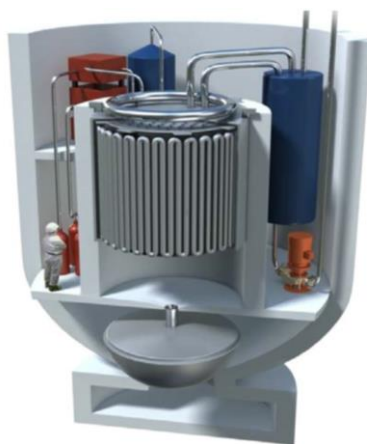
Obrázek 20: Koncept dánského solného reaktoru MSTW [33]
