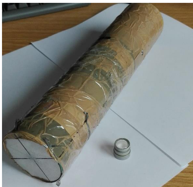
Obr. 9. Detekční sonda se stilbenovým krystalem používaná pro měření spekter neutronů na pracovištích LR-0 a LSM
