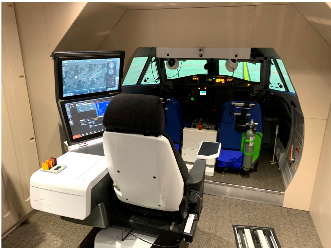
Obrázek 17: Simulátor L 410 - vnitřní prostor včetně instruktorské stanice
