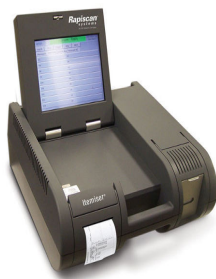
Obrázek 5.4: Zařízení Itemiser DX pro stopovou detekci výbušnin [28]
