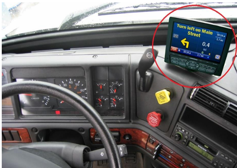
Obrázek 4. Palubní počítač (OBU) systému CarrierWeb [23]
