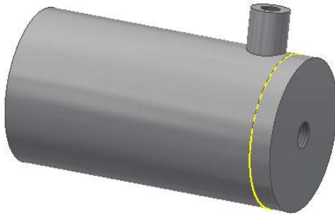
Obr. 33.: Umístění svaru dno válce – ovládací válec
