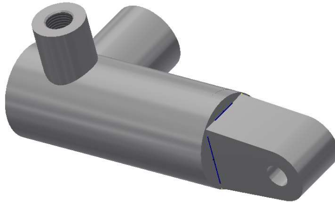
Obr. 31.: Umístění svaru úchyt – dno válce
