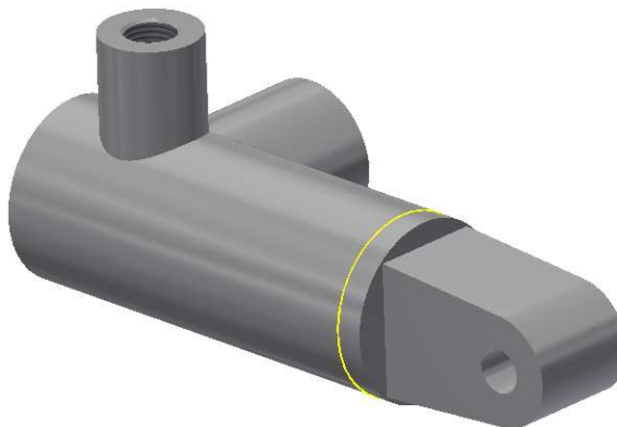
Obr. 32.: Umístění svaru dno válce – spouštěcí válec
