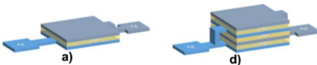
Obr. 10 3D zobrazení deskových kondenzátorů a) s jednou, b) s více vrstvami dielektrika, převzato z [16]
