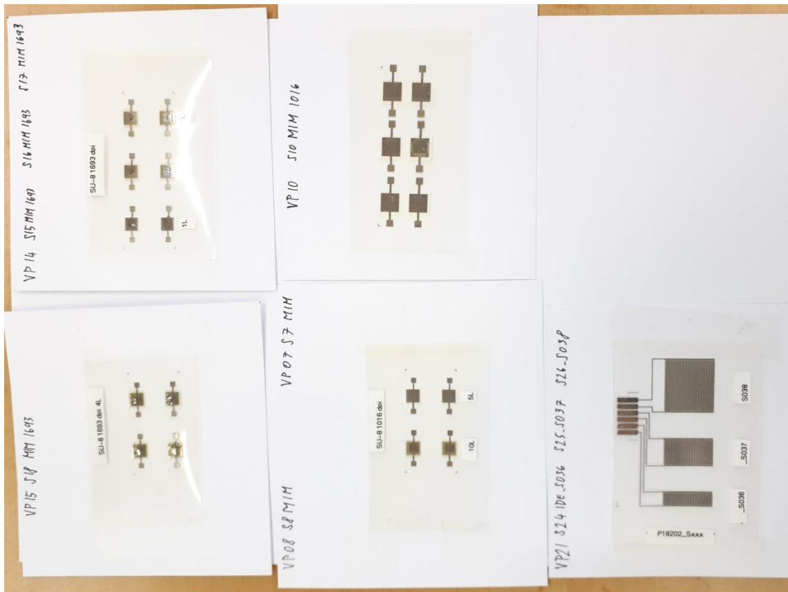
Obrázek 8 Interdigitální a deskové kondenzátory tištěné na PET folii
