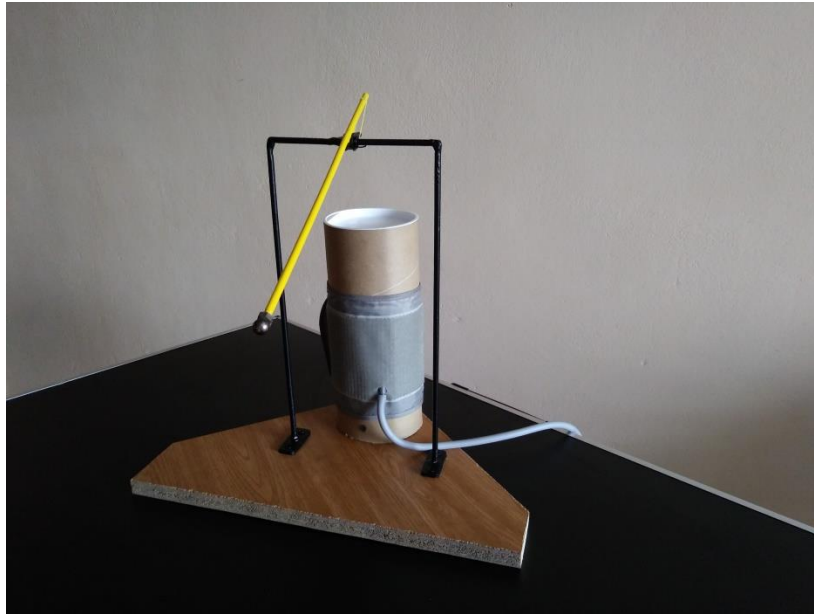
Obr. 4.18: Sústava s kyvadlom pred prestrihnutím gumičky, kedy je kyvadlo s guľôčkou v ustálenom stave
