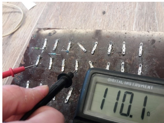
Obr. 11 - Zapojení rezistorů sériově s ohmmetrem.
