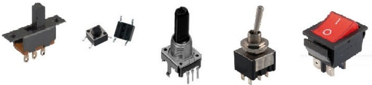
Obr. 3 - Zleva: posuvný, mikro, otočný, páčkový, kolébkový (převzato z www.gme.cz )
