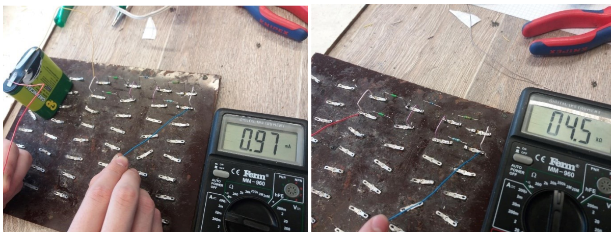
Obr. 14- Reální zapojení Sério-paralelních rezistorů, ohmmetru a ampérmetru
