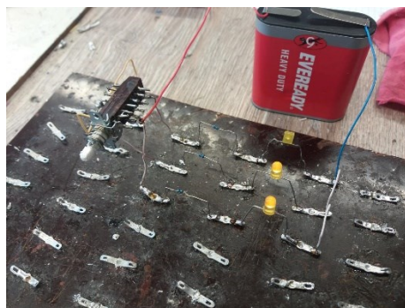
Obr. 7 - Schéma více pólového spínače a tři LED s rezistory v obvodu s plochou baterií.
