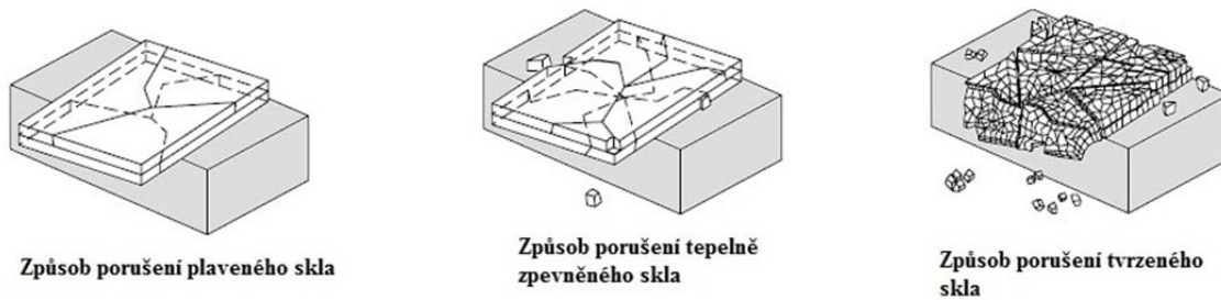
Obr. 2.4: Porušení vrstvených skel různého druhu [8].
