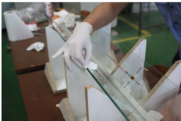
Obr. 6.5: Příprava povrchu lepené hrany
