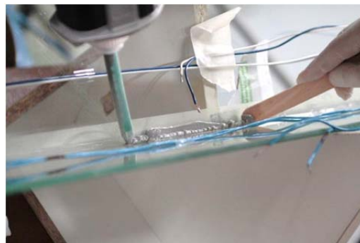
Obr. 6.8: Odstranění přebytečné vrstvy lepidla
