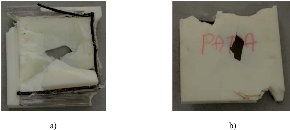
Obr. 7.16: Porušená podložka a) přední strana plastové podložky, b) zadní strana plastové podložky
