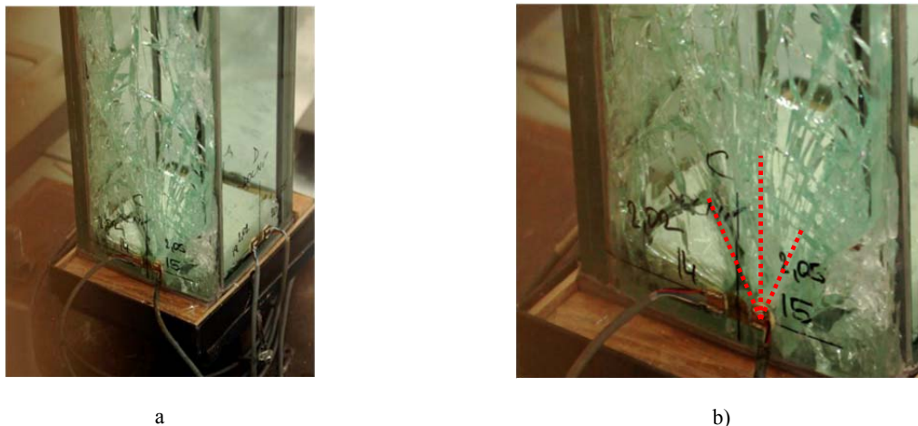
Obr. 7.20: Zkušební těleso S 2.05 a) počáteční trhliny na panelu C, b) detail
