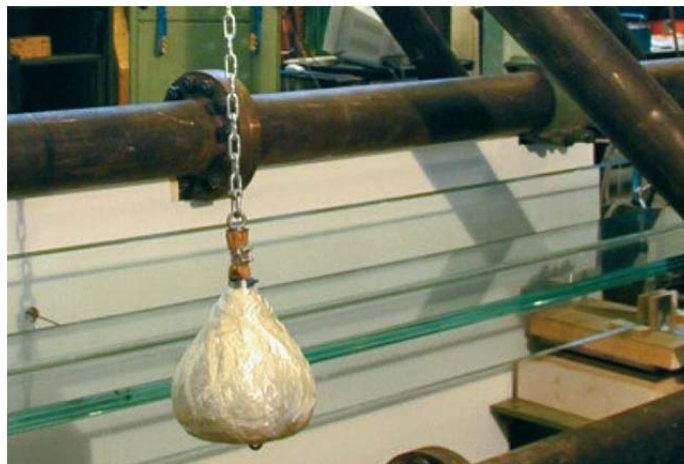
Obr. 3.6: Soustředěné břemeno na konci průběžného ramene [12]
