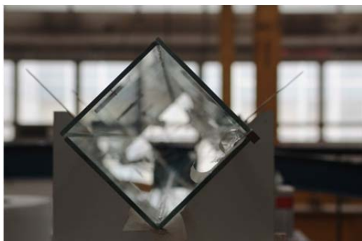
Obr. 6.9: Průřez dříku skleněného sloupu
