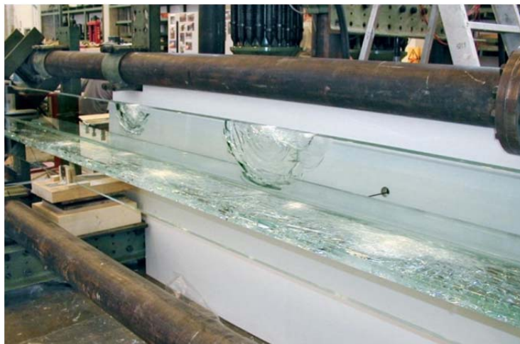
Obr. 3.7: Sloup v závěrečné fázi zkoušky [12]
