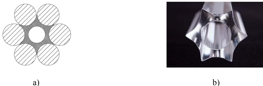
Obr. 3.15: Skleněný sloup složený z násobného množství tyčí, a) průřez experimentálního vzorku složeného ze šesti tyčí, b) jádro experimentálního prvku, CONTURAX [20]
