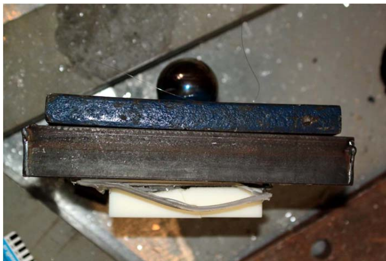
Obr. 7.19: Deformovaná ocelová pata
