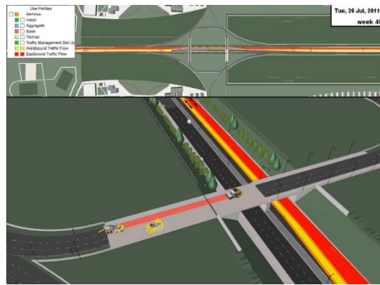
Obrázek 13 - Infrastrukturní 4D BIM
