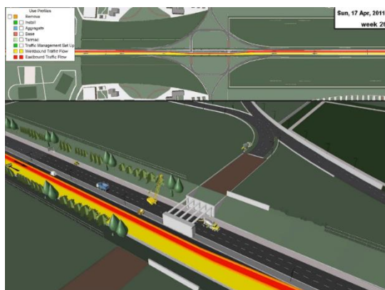
Obrázek 12 - Infrastrukturní 4D BIM
