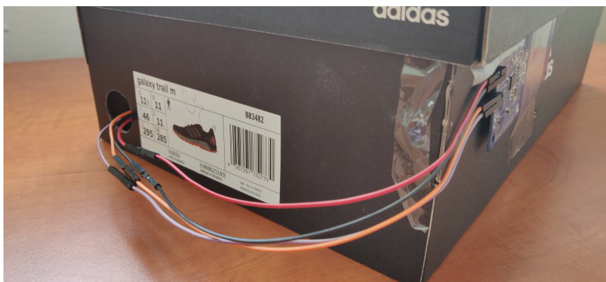
Obr. B.2: Detail na vyvedenie káblov pre čítačku kariet z krabice.
