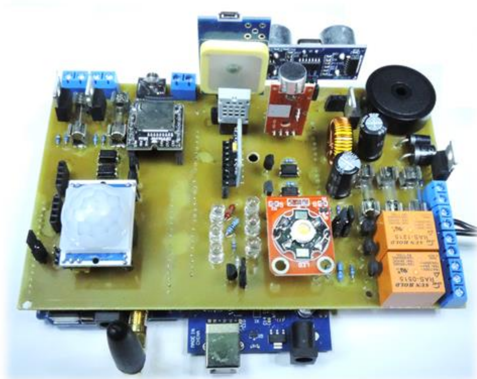
Obrázek 25 - Osazený plošný spoj, hotový přípravek
