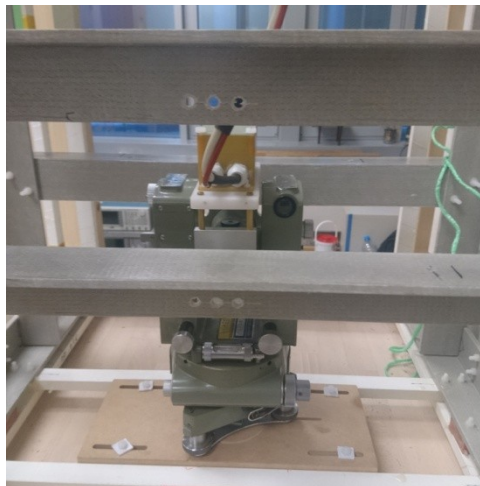
Obr. 4-22 CTUMAG magnetometr na teodolitu v cívkách
