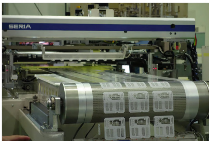
Obrázek 3: Roll-to-Roll výroba RFID tagu na PET substrát, převzato z: [5]
