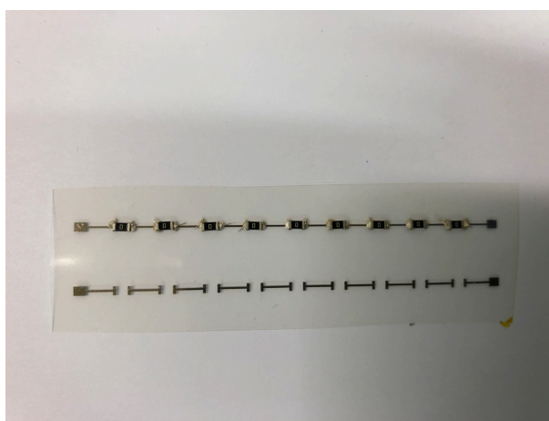
Obrázek 34: Testování odporu kontaktů a vodivé cesty
