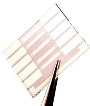
Obrázek 2.7: Interdigitální ITO substrát dodaný od Ossila [16]
