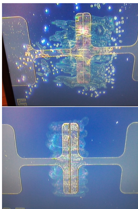
Obrázek 3.2: Fotografie natisknutých inkoustů, připravený v laboratoři (nahore), dodaný od Sigma-Aldrich (dole)
