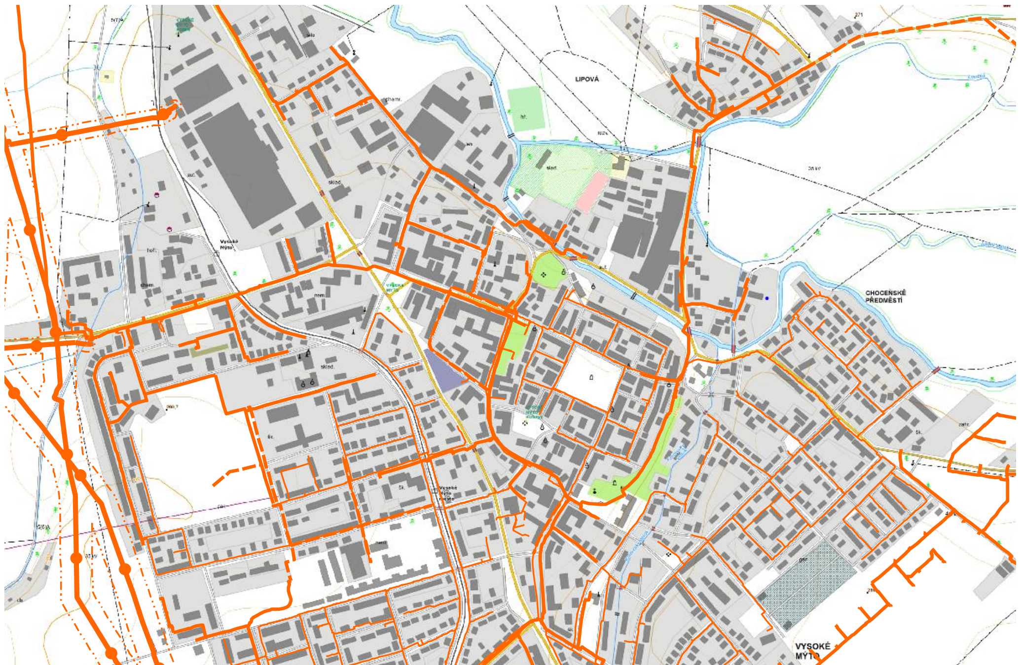
C.2 MAPA TECHNICKÉ INFRASTRUKTURY | VEDENÍ PLYNOVODU
