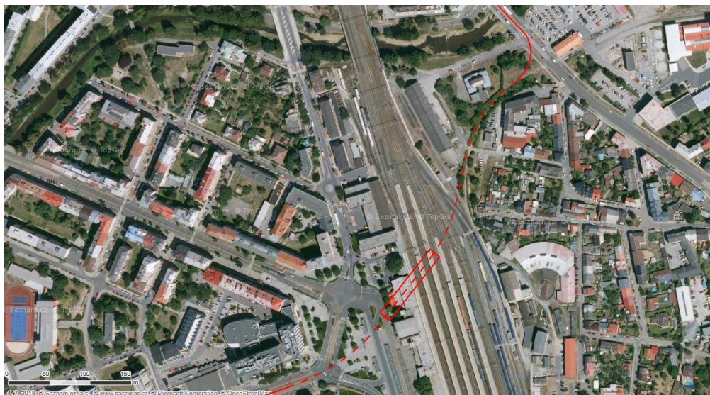
Obr. 22. Ortofotomapa oblasti hlavního nádraží se zakresleným tramvajovým tunelem dle varianty 3 ([50], úpravy autor)
