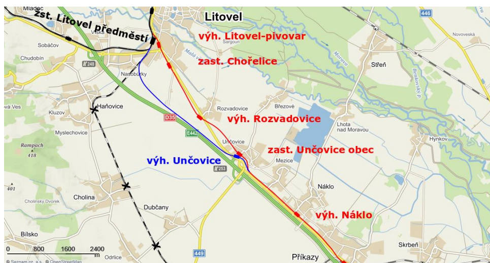
Obr. 20. Situace variantního vedení novostavby tratě v úseku Unčovice – Litovel; modře železniční trať, červeně tramvajová trať ([49], úpravy autor)
