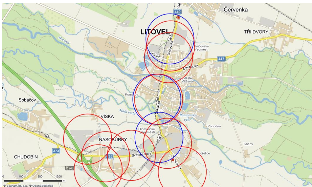
Obr. 7. Isochrony pěší dostupnosti 500 m tarifních bodů autobusové (červeně) a železniční dopravy (modře) pro město Litovel ([29], úpravy autor)
