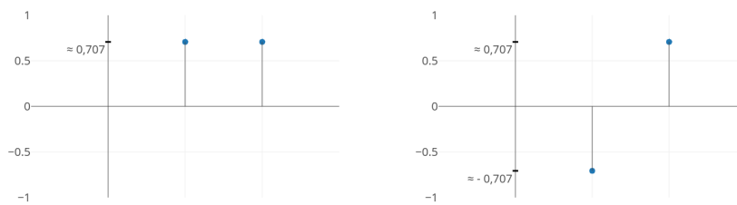
(a) Dolní propust pro dekompozici (b) Horní propust pro dekompozici
