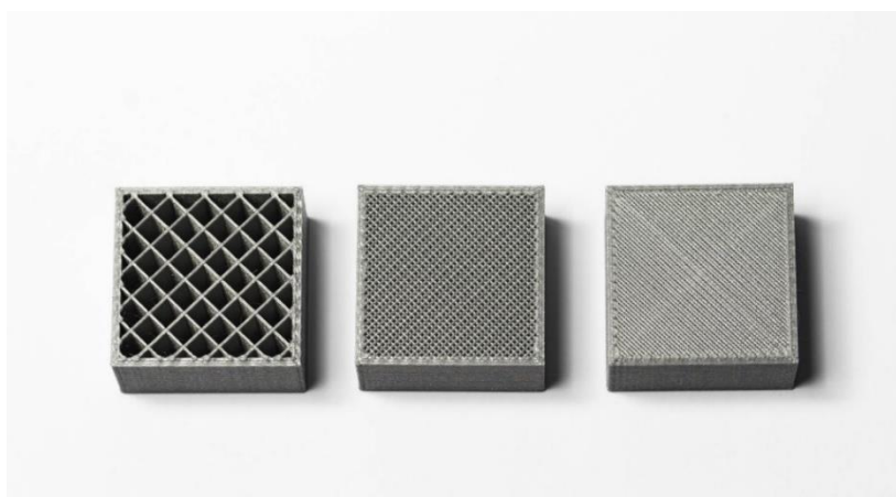
2.9. Obrázok: Rôzne výplne vytlačeného objektu [1]
