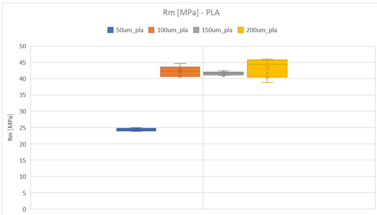
5.7. Graf: Namerané hodnoty pevnosti u materiálu PLA pri rôznych rozlíšeníach tlače
