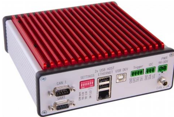
Obrázek 3.7 - MGB grabber (zdroj: digiteqautomotive.com)
