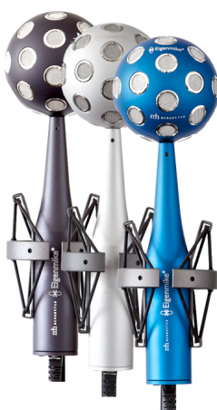
Obrázek 1.7: Eigenmike microphone - mikrofon pro ambisonii 4. řádu (převzato z [7])
