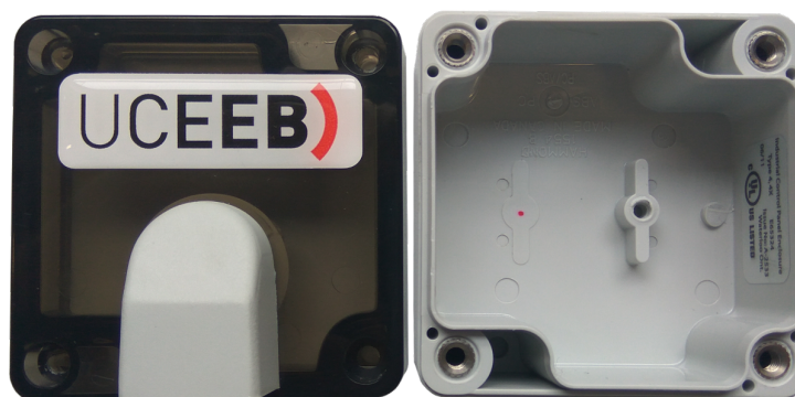
Obrázok 5.1: Krabička externého čidla po úpravách
