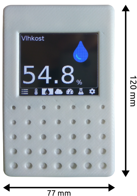
Obrázok 4.5: Výsledná podoba centrálnej jednotky IAQ s LCD displejom
