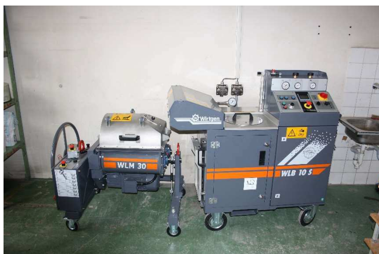
Obrázek 2: Laboratorní sestava tvořená míchačkou a pěnojednotkou
