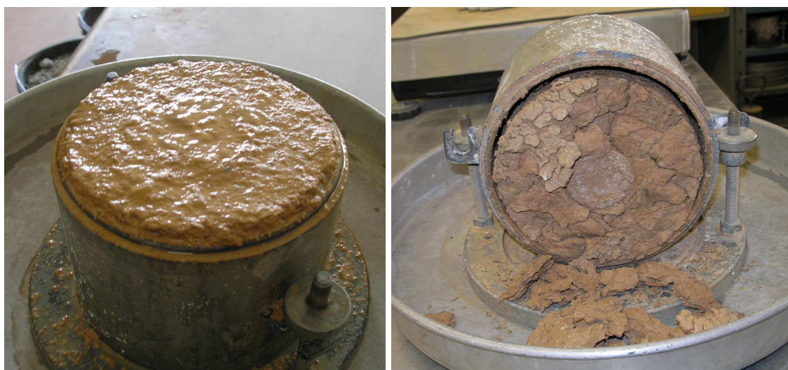
Obrázek 65: Vzorek F8 CH po saturaci (vlevo) a následném vysušení (vpravo)
