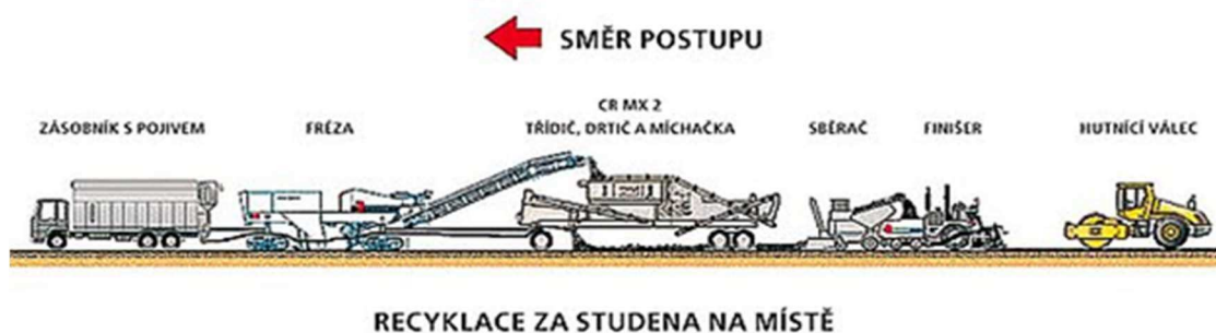
Obrázek 4: Postup recyklace za studena [Solařová 2007]
