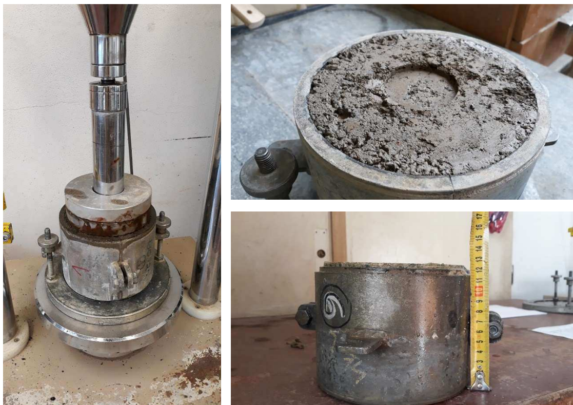
Obrázek 40: Sestava pro měření CBR (vlevo); vzorek po zkoušce CBR (vpravo nahoře); příklad lineárního bobtnání (vpravo dole)
