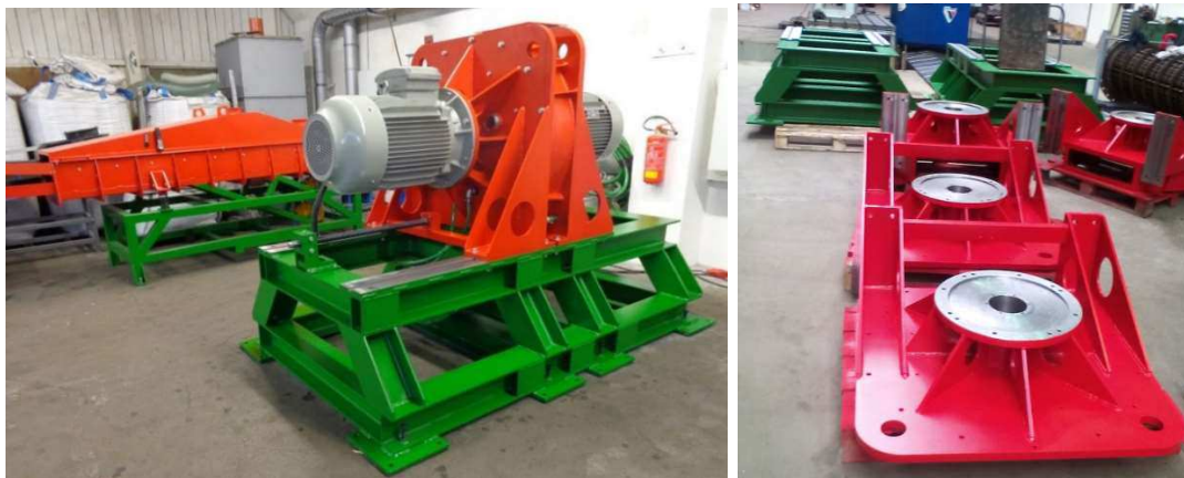
Obrázek 22: Vysokorychlostní mlýn (vpravo); rozevřené mezikruží rotorů pro osazení mlecích elementů (vlevo) [Valentin 2016]
