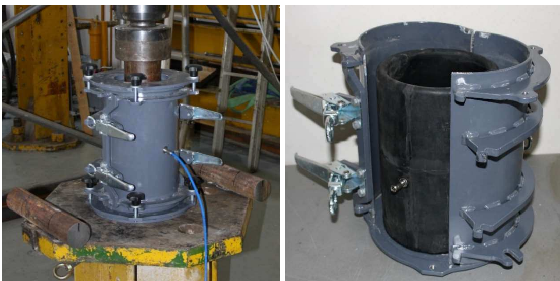
Obrázek 42: Zatěžování zkušebního tělesa během zkoušky (vlevo), detail formy s gumovou membránou uvnitř (vpravo)
