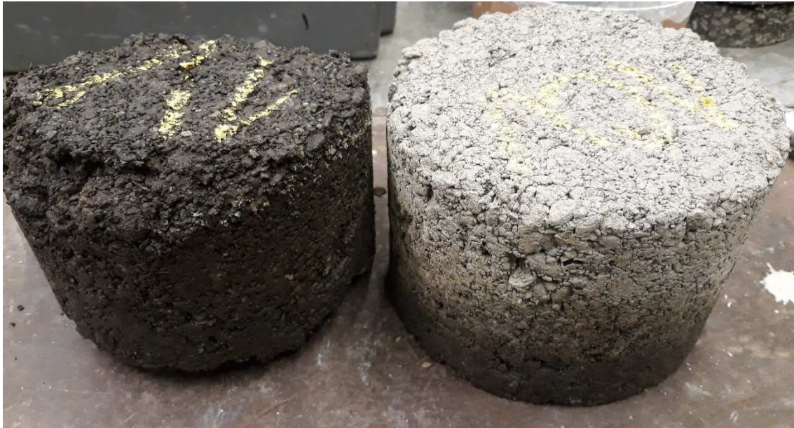
Obrázek 84: Tělesa po zmrazovacích cyklech (vlevo AP-SK, vpravo AP-SK+cement)
