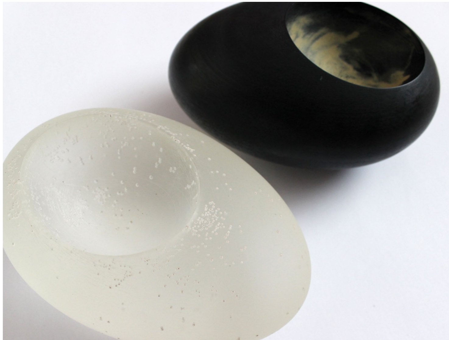
Model z 3D tiskárny a jeho odlitek z pryskyřice
