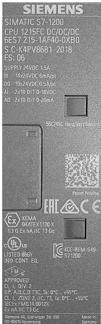
Obr. A-5: Štítky PLC SIMATIC S7-1200 (vlevo), zdroje SIMATIC PM 1207 (uprostřed), kom. modulu CM 1241 (vpravo)
