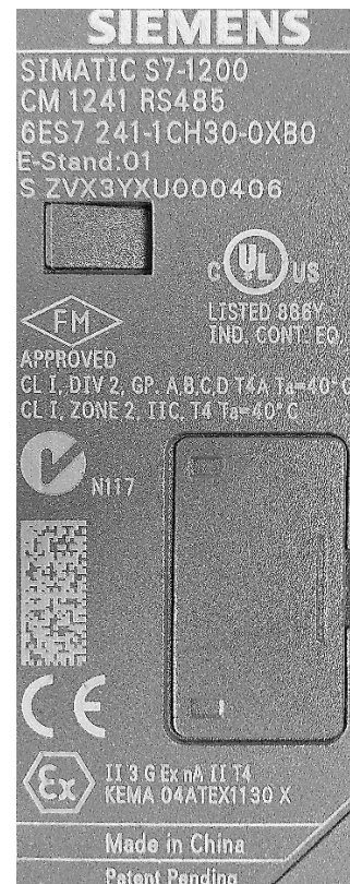
Obr. A-5: Štítky PLC SIMATIC S7-1200 (vlevo), zdroje SIMATIC PM 1207 (uprostřed), kom. modulu CM 1241 (vpravo)
