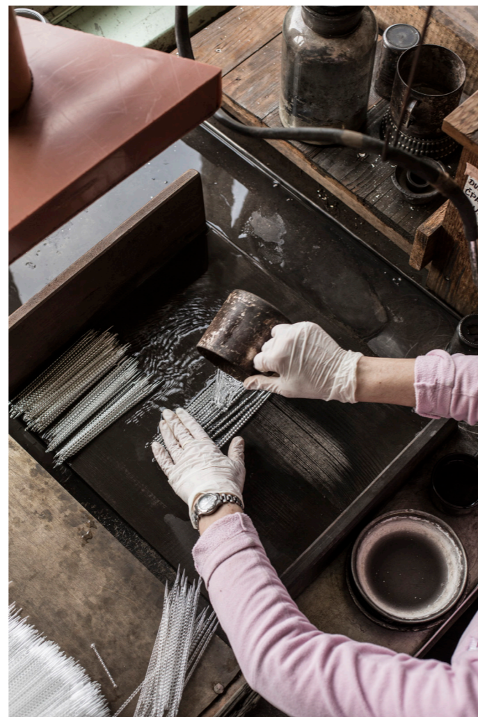
21 Ukázka během stříbření, kdy se perle polévají horkou vodou pro urychlení reakce a zároveň se omyjí
