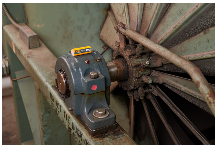
Obrázek 2.5: Upevnění Fluke senzoru k motoru. Převzato z [8].
