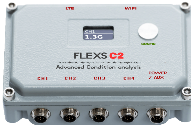
Obrázek 2.6: FlexSCADA Condition Analyzer. Převzato z [7].
