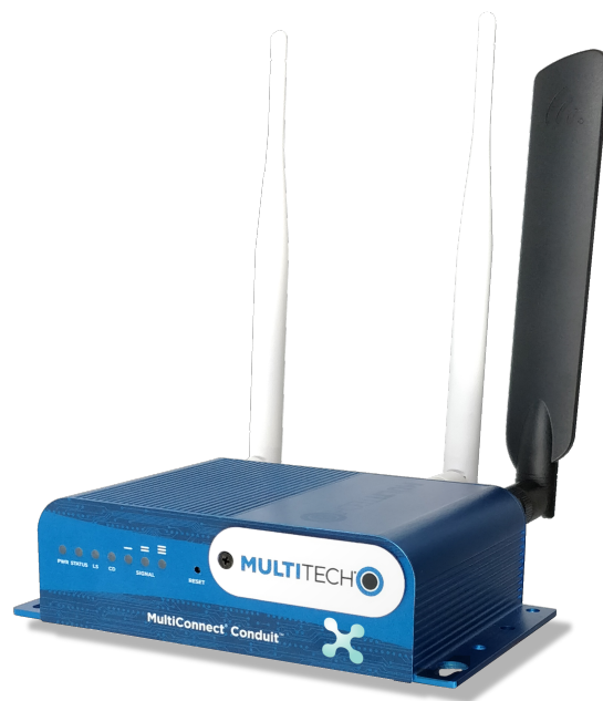
Obrázek 3.5: Oficiální LoRa brána od firmy Multitech využívající čipy SX13xx. Převzato z [17].
