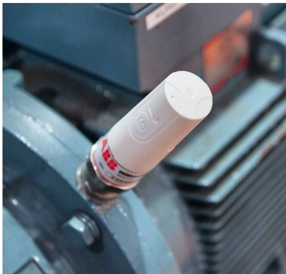
Obrázek 2.1: Upevnění senzoru ABB WiMon k motoru. Převzato z [1].
