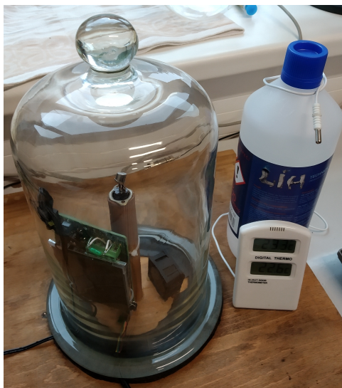
Obrázok 3.13: Aparatúra na presné meranie koncentrácie plynu vo vzduchu
