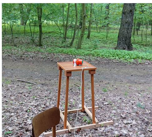
(a) : Umístění senzoru protonového magnetometru při měření
