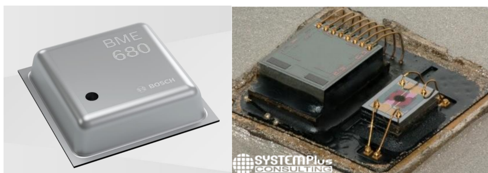
Obrázek 3.4: Senzor BME680 a jeho vnitřní struktura [12]
