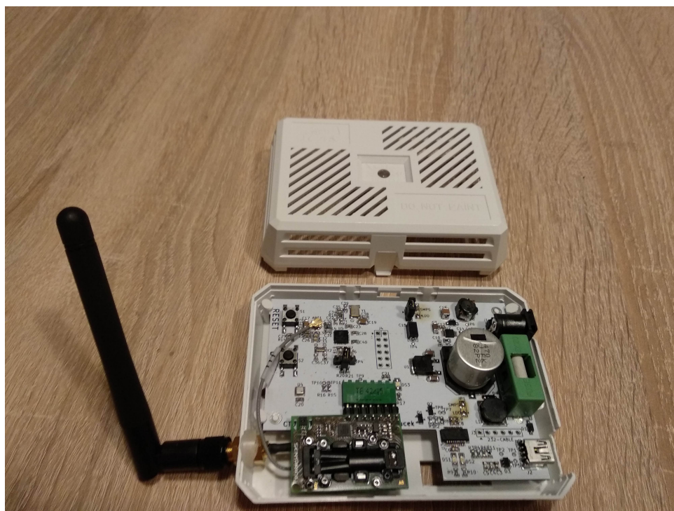
Obrázek 5.5: Systém pro monitorování prostředí
