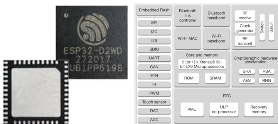
Obrázek 3.1: Pouzdro ESP32-D2WD [9] a blokové schéma ESP32 [1]
