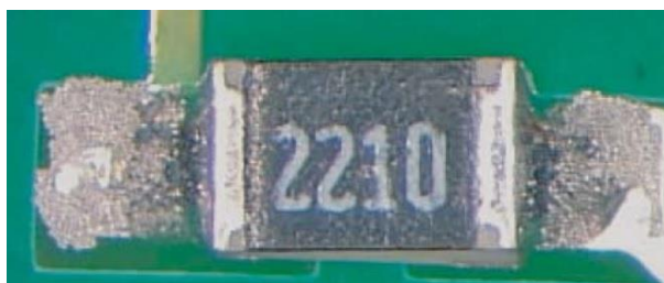
Obr. 29 Nedostatečné přetavení pájecí pasty [4]
