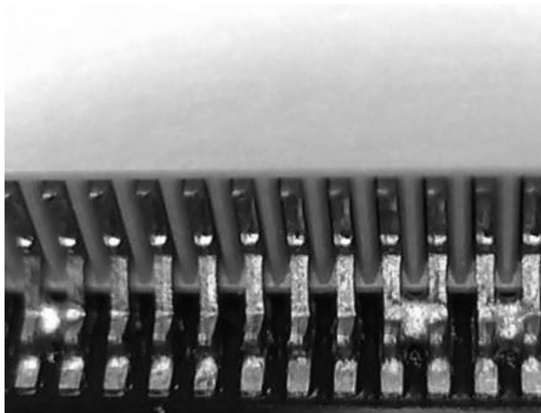
Obr. 49 Zkrat nožiček součástky [13]
