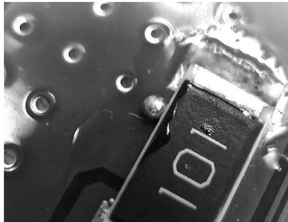
Obr. 52 Kulička vedle součástky [13]
