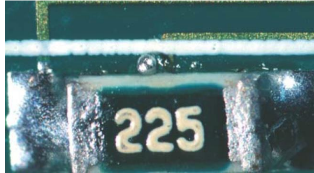
Obr. 31 Kulička vedle součástky [4]
