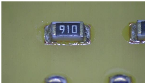
Obr. 41 Zapájený referenční rezistor s ideálním množstvím pájecí pasty [13]
