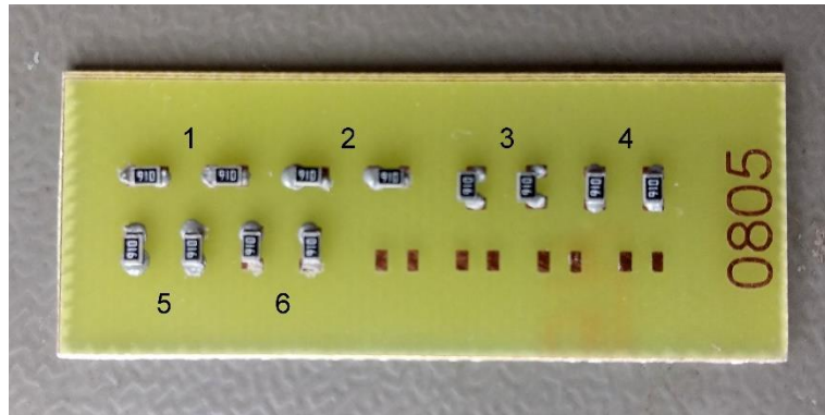
Obr. 38 Destička pro experiment 1 s osazenými součástkami [13]
