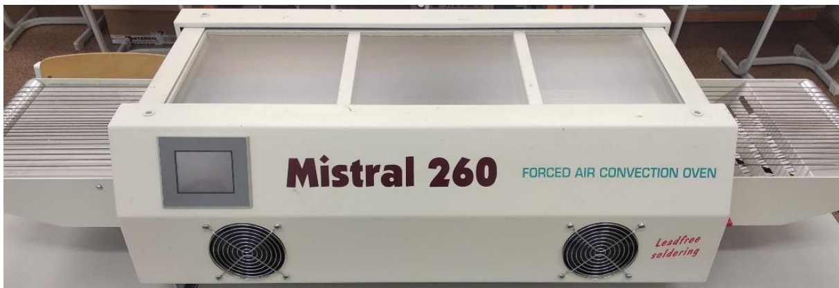
Obr. 39 Pájecí pec Mistral 260 [13]
