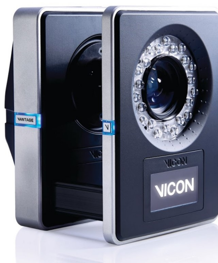
(a) : Kamery snímající prostor se zdrojem infračerveného světla
