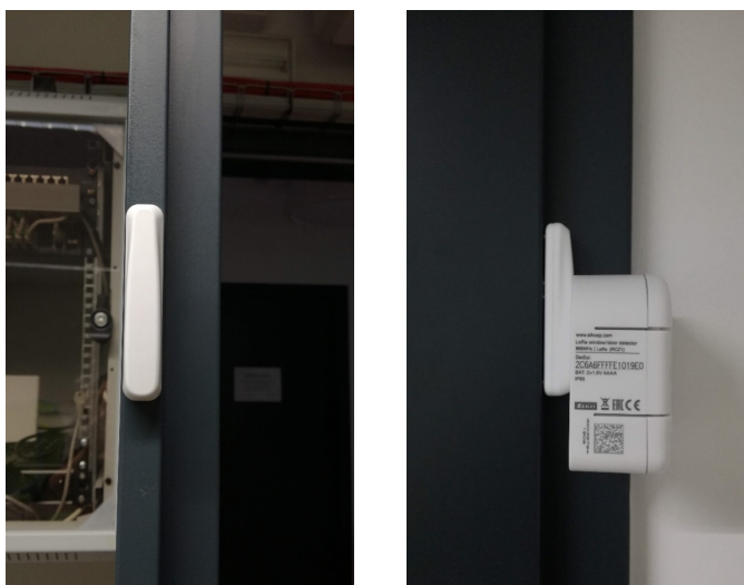
Obrázek 26 Umístění magnetického detektoru – vchodové dveře (vlastní fotografie)
