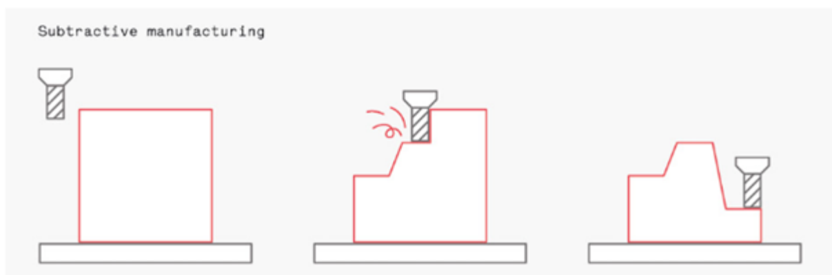
OBR. 2 SUBTRAKTIVNÍ VÝROBA (REDWOOD ET AL. 2017)
