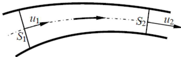
Obrázek 3.8.1: Princip rovnice kontinuity, proudění kapaliny při proměnném průřezu (Barták, 2010)
