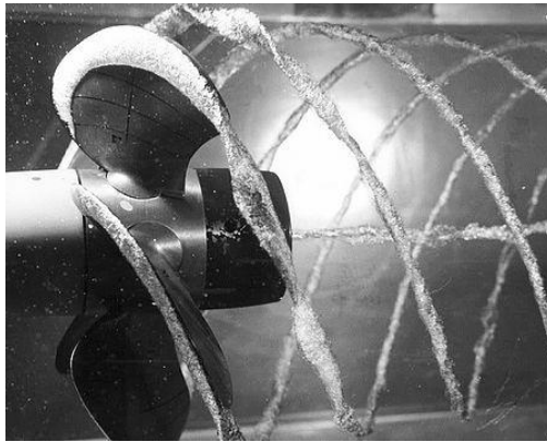
Obrázek 3.13.1: Vznik kavítace na lodním šroubu (Kavítace 2019)
