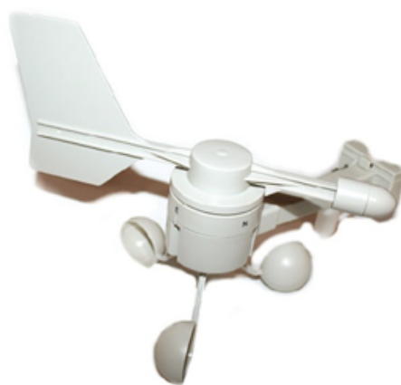
Obrázek 2.7: Meteostanice s měřením proudu vzduchu, tlaku, teploty a dalších veličin
