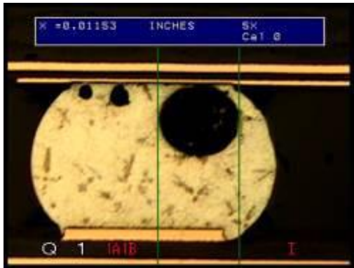
Obrázek 22. Makrovoidy v pájeném spoji [3]
