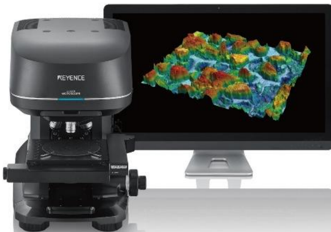
Obrázek 32. Konfokální mikroskop VK-X1000 [34]
