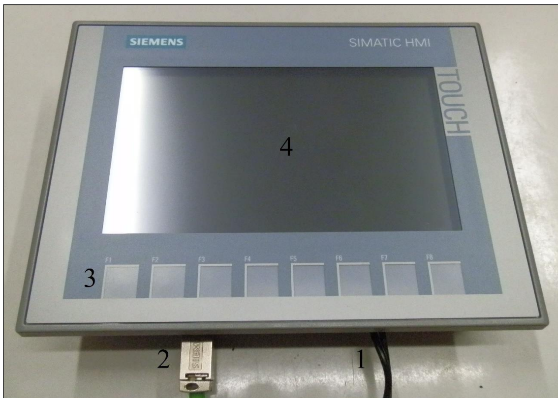
Obr. 15: Dotykový panel; 1) stejnosměrné napájení 24 V, 2) komunikační výstup, 3) řada s 8 tlačítky, kterým lze programově přiřadit libovolnou funkci, 4) dotyková plocha s úhlopříčkou 7 palců (17,8 cm). Pozn.: v blízkosti napájecího konektoru se nachází uzemňovací svorka (vodič připojen později, není na snímku)
