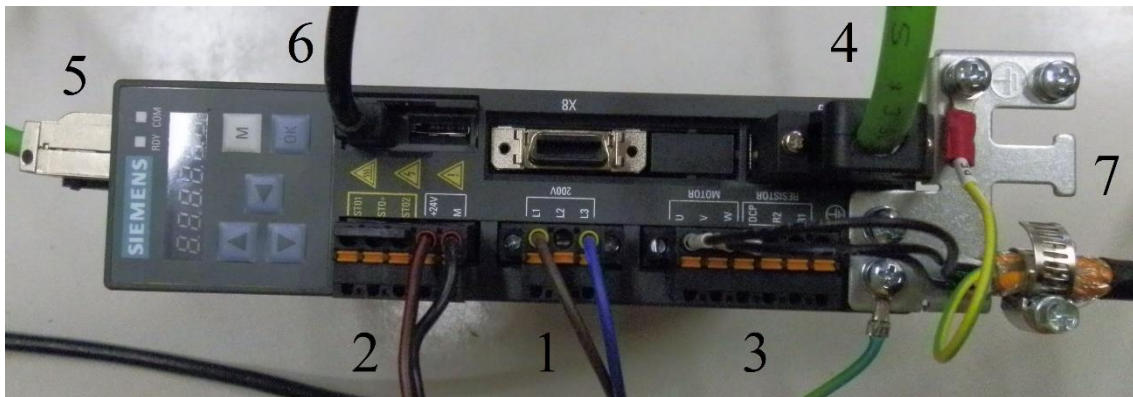
Obr. 10: Výkonový měnič V90; 1) napájení 230 V AC, 2) napájení 24 V DC, 3) napájení motoru, 4) vstup signálu z enkodéru, 5) ethernetová linka, 6) USB výstup pro komunikaci programu V-Assistant s měničem a nahrávání dat do vnitřní paměti měniče. Pozn. Konektor 2) obsahuje též piny pro aktivaci funkce STO
