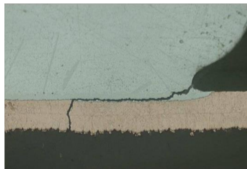
Obrázek 36 "Pad cratering" s prasklinou šířící se skrz vodivou cestu [38]
