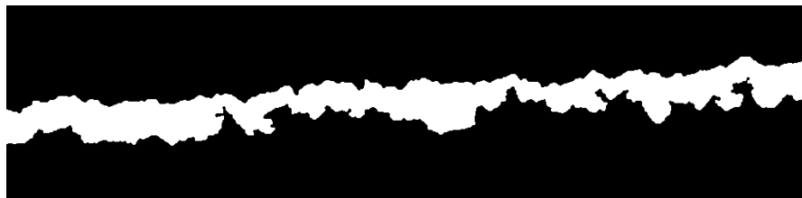
Obrázek 51 Obráz – binární mapa IMC sloužící k výpočtu její tloušťky
