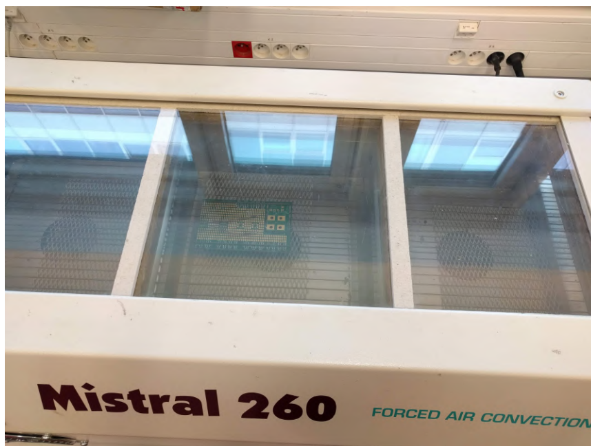
Obrázek 3.7: Měření teplotního profilu pomocí termočlánků.
