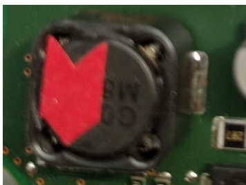
Obrázek 4.3: Pohled na vychýlenou cívku, vyhodnocenou automatickou optickou kontrolou jako riziková.
