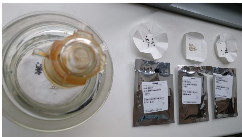
Obrázek 3.4: Součástky ponechané působení vlhkosti v exikátoru a v místnosti.
