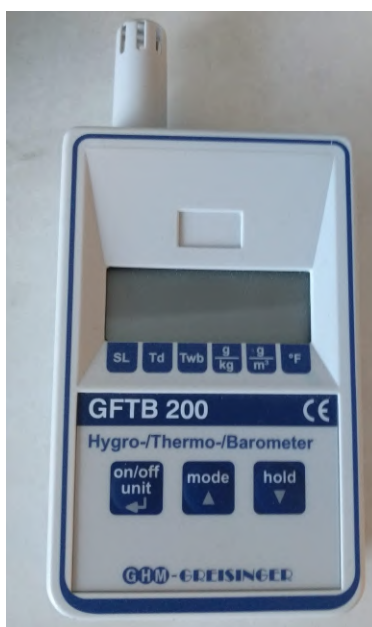
Obrázek 3.3: Použitý vlhkoměr, teploměr a tlakoměr GREISINGER GFTB 200.
