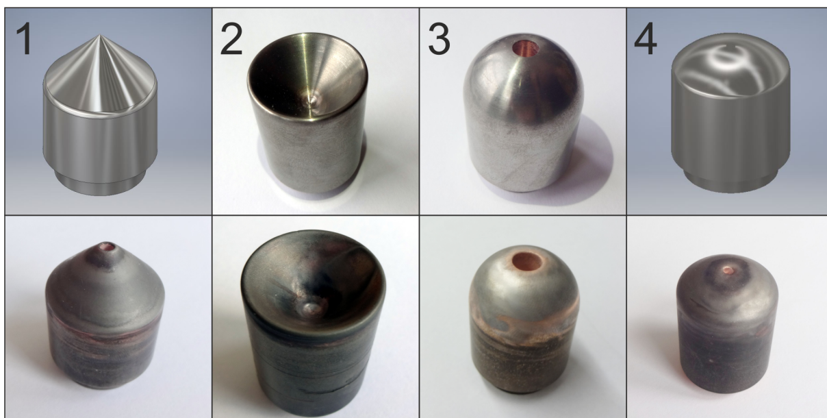
Obrázek 4.1: Zobrazené anody před (horní řada) a po experimentu (dolní řada), 1-Plný kužel, 2-Dutý kužel, 3-Zaoblená s otvorem, 4-Zaoblená hladká. Vzorky 1 a 4 před experimentem jsou zobrazeny ve 3D modelu za použití PC softwaru Autodesk Inventor 2019.
